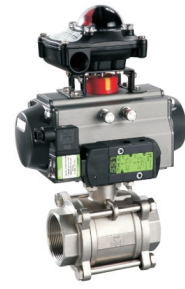
品名：气动内螺纹球阀 公称通径：DN10-100 公称压力：PN16-320 作用型式：开关型/调节型 阀体材质：铸钢/不锈钢 阀座材质：PTFE/PPL 附件：电磁阀/限位开关/气源三联件/手轮/定位器
