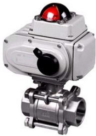
品名：电动内螺纹球阀 公称通径：DN10-100 公称压力：PN16-320 作用型式：开关型/调节型 阀体材质：铸钢/不锈钢 阀座材质：PTFE/PPL 电压：DC24/AC24V/DC220 /AC220/AC380
