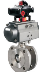
品名：气动超薄球阀 公称通径：DN15-150 公称压力：PN16-40 作用型式：开关型/调节型 阀体材质：铸钢/不锈钢 阀座材质：PTFE/PPL 附件：电磁阀/限位开关/气源三联件/手轮/定位器
