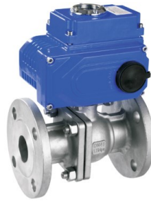
品名：电动法兰球阀 公称通径：DN15-400 公称压力：PN16-320 作用型式：开关型/调节型 阀体材质：铸钢/不锈钢 阀座材质：PTFE/PPL/H/Y 电压：DC24/AC24V/DC220/AC220
