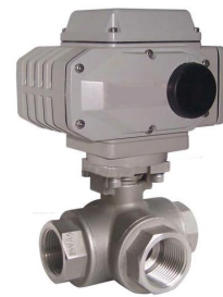
品名：电动三通球阀 公称通径：DN15-300 公称压力：PN16-320 作用型式：开关型/调节型 阀体材质：铸钢/不锈钢 阀座材质：PTFE/PPL/H/Y 电压：DC24/AC24V/DC220 /AC220/AC380
