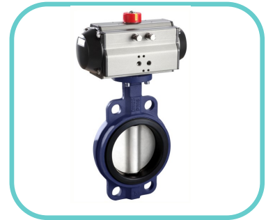
品名：气动软密封蝶阀 公称口径：DN50-800 公称压力：PN10-16 作用型式：开关型/调节型 阀体材质：铸铁/铸钢/不锈钢 阀座材质：橡胶 附件：电磁阀/限位开关/气源三联件/手轮/定位器
