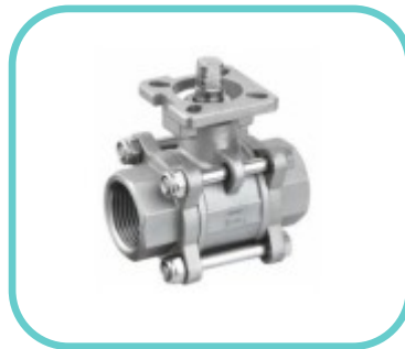
品名：三片式高平台螺纹球阀 规格：1/4"-4" 材质：CF8/CF3/CF8M/CF3M/ WCB 压力：1000WOG/PN64 带锁/不带锁
