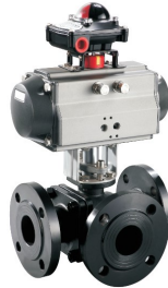
品名：气动三通球阀 公称通径：DN15-300 公称压力：PN16-320 作用型式：开关型/调节型 阀体材质：铸钢/不锈钢 阀座材质：PTFE/PPL/H/Y 附件：电磁阀/限位开关/气源三联件/手轮/定位器
