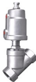
品名：全不锈钢气动螺纹角座阀 介质温度：-20℃~+180℃ 环境温度：-20℃~+60℃ 气源压力：0.3~0.8MPa 公称口径：DN15-DN100 公称压力：PN16 阀体材质：CF8/CF8M 阀座材质：PTFE
