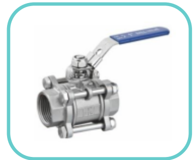
品名：三片式螺纹球阀 规格：1/4"-4" 材质：CF8/CF3/CF8M/CF3M/ WCB 压力：1000WOG/PN64
