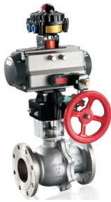
品名：气动法兰球阀 公称通径：DN15-400 公称压力：PN16-320 作用型式：开关型/调节型 阀体材质：铸钢/不锈钢 阀座材质：PTFE/PPL/H/Y 附件：电磁阀/限位开关/气源三联件/手轮/定位器
