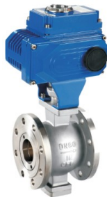
品名：电动V型球阀 公称通径：DN25-500 公称压力：PN16-320 作用型式：开关型/调节型 阀体材质：铸钢/不锈钢 阀座材质：PTFE/PPL/H/Y 电压：DC24/AC24V/DC220 /AC220/AC380
