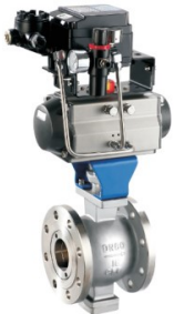
品名：气动V型球阀 公称通径：DN25-500 公称压力：PN16-320 作用型式：开关型/调节型 阀体材质：铸钢/不锈钢 阀座材质：PTFE/PPL/H/Y 附件：电磁阀/限位开关/气源三联件/手轮/定位器
