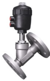
品名：气动法兰角座阀 介质温度：-20℃~+180℃ 环境温度：-20℃~+60℃ 气源压力：0.3~0.8MPa 公称口径：DN15-DN100 公称压力：PN16 阀体材质：CF8/CF8M 阀座材质：PTFE
