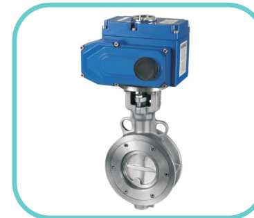
品名：电动硬密封蝶阀 公称口径：DN50-800 公称压力：PN10-25 作用型式：开关型/调节型 阀体材质：铸钢/不锈钢 阀座材质：H/Y 电压：DC24/AC24V/DC220 /AC220/AC380
